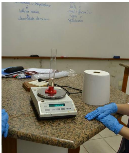
Figura 3. Testes para a determinação da massa dos líquidos.
